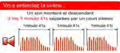
Le signal d'alerte consiste en 3 cycles successifs d'une durée d'1 minute et 41 secondes chacune et séparées par un intervalle de 5 secondes.
