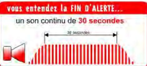
Le signal de fin d'alerte consiste en une émission continue d'un son à fréquence fixe d'une durée de 30 secondes.
